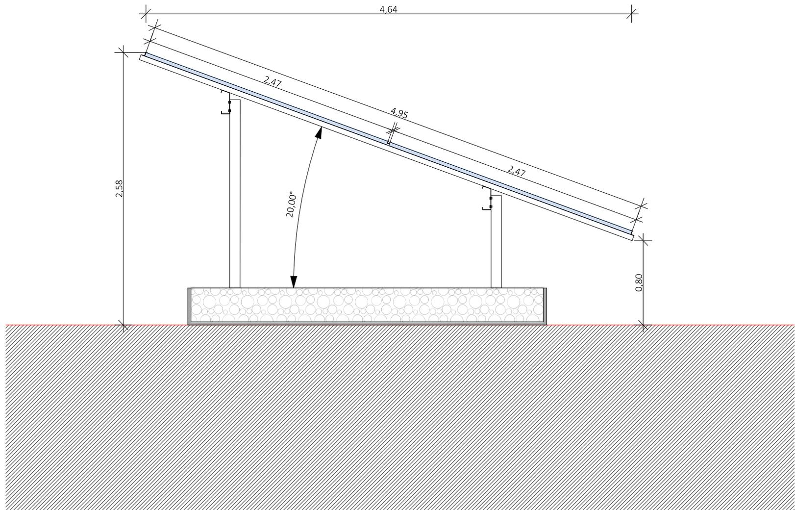
Detail d'une structure photovoltaïque 20°
